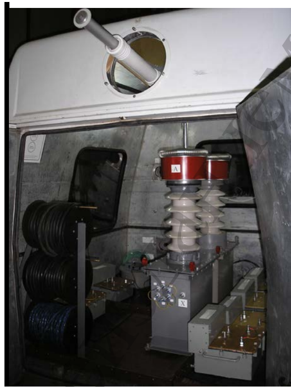
Рис. 8. Индуктивный эталонный тороидальный трансформатор напряжения класса 110 кВ: а – подготовка трансформатора к испытаниям в лабораторном зале; б – трансформатор, смонтированный внутри мобильной поверочной лаборатории [13]
