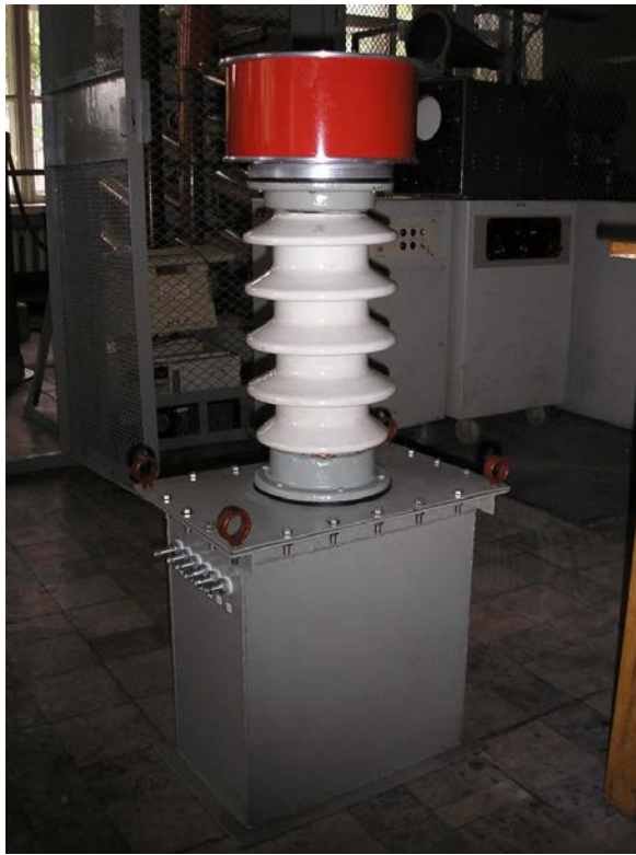
Рис. 8. Индуктивный эталонный тороидальный трансформатор напряжения класса 110 кВ: а – подготовка трансформатора к испытаниям в лабораторном зале; б – трансформатор, смонтированный внутри мобильной поверочной лаборатории [13]
