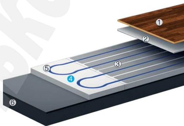
Рис. 1. Схема системи підлогового опалення сухого монтажу:
