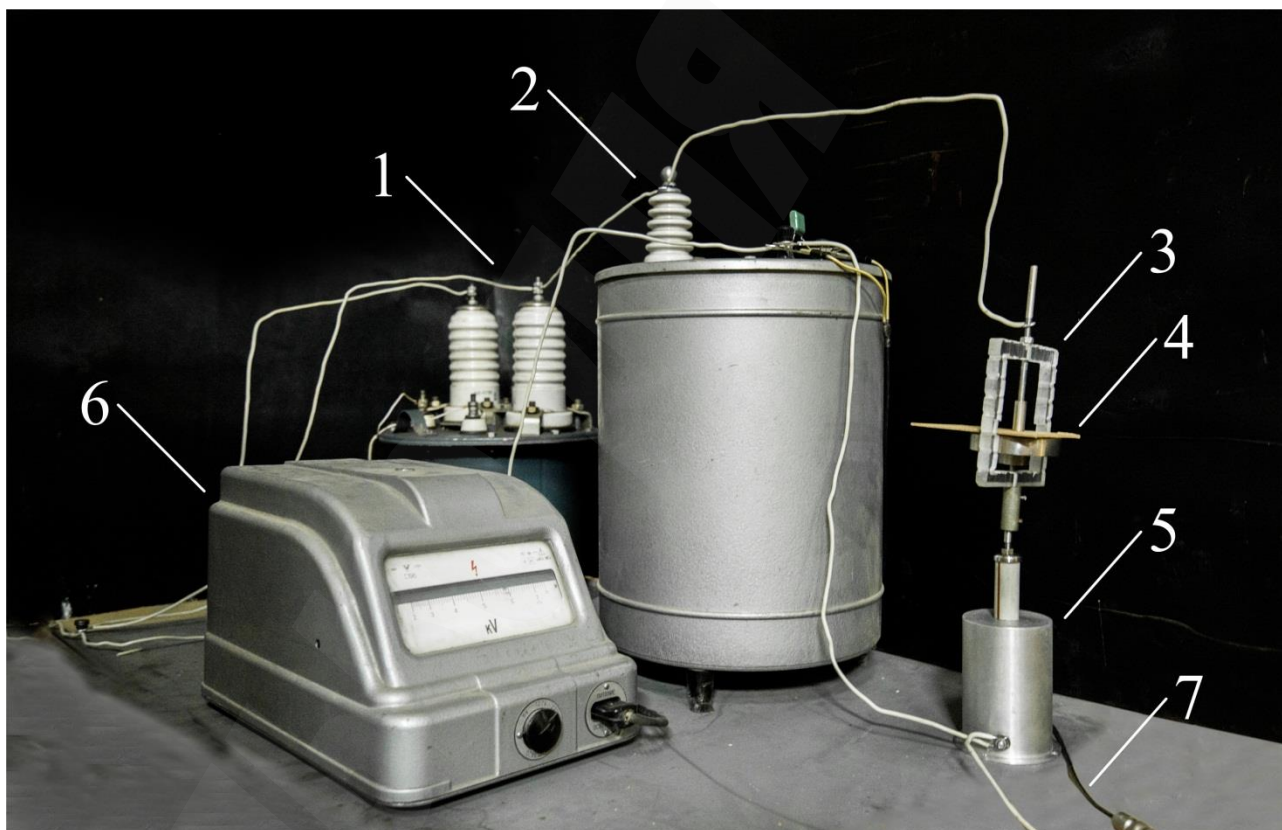
Рис. 1. Фотография экспериментальной установки для измерения характеристик частичных разрядов: 1 – повышающий трансформатор; 2 – соединительный конденсатор; 3 – объект измерения; 4 – электротехнический картон (элемент объекта измерения); 5 – экран фильтра верхних частот; 6 – киловольтметр; 7 – кабель для присоединения к усилителю и осциллографу
