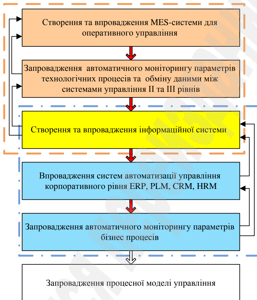
Рис. 3. Підхід до поетапної автоматизації управління газотранспортною системою України
