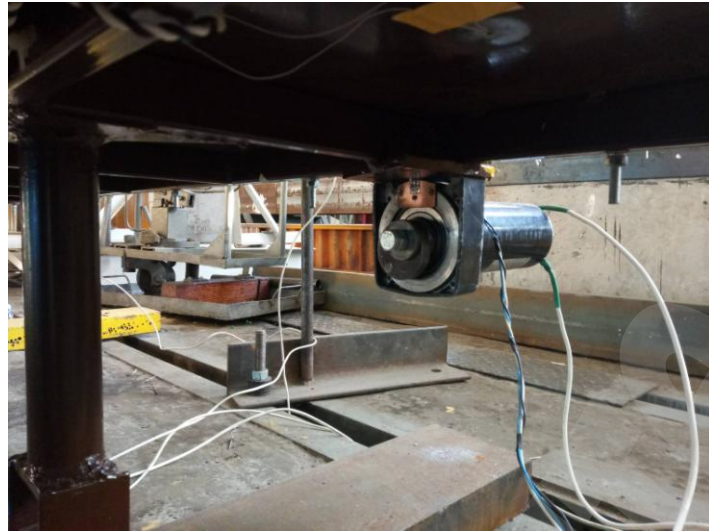
Рис. 3. Збуджувач коливань з датчиком положення дебаланса
