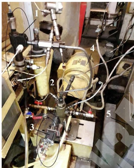
**Рис. 6.** Система впрыскивания топлива с датчиками на безмоторном стенде: 1 – форсунка; 2 – топливный насос высокого давления (ТНВД); 3 – устройство, управляющее перемещением рейкой ТНВД; 4 – электродвигатель; 5 – станция управления электродвигателем
