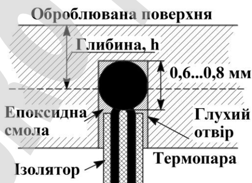
Рис. 4. Закладення термопари
