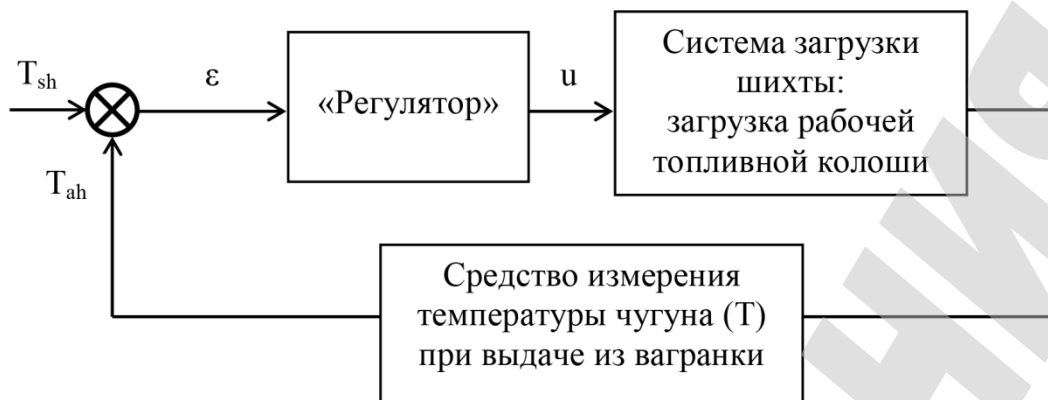
Рис. 11. Структурная схема регулятора температуры
