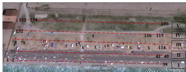
Рис. 2. Схема сети точек наблюдений на участке обследования Условные обозначения: — расположение профилей; I–V — номера профилей; 1...190 — номер и положение точки регистрации ЕИЭМПЗ
