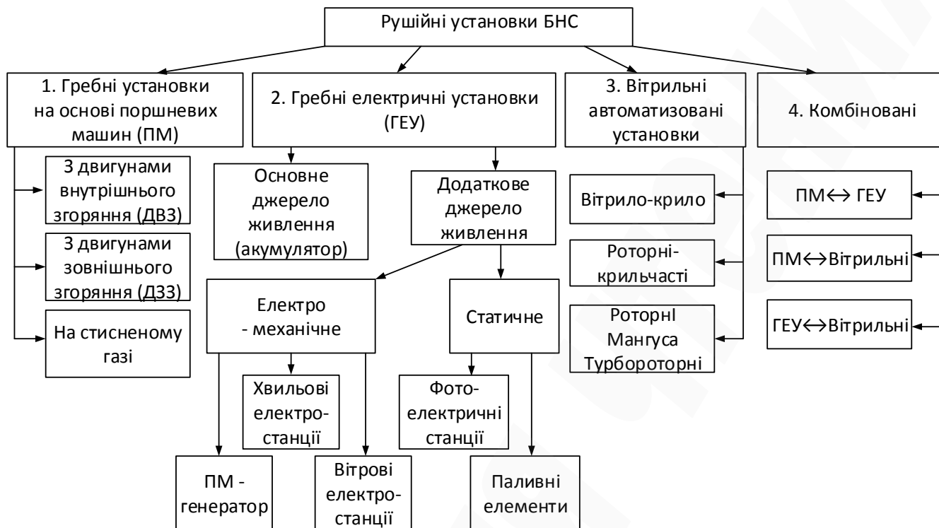
Рис. 1. Типи рушійно-кермовий комплексів (РКК), що можуть бути застосовані в безекіпажних надводних суднах (БНС)
