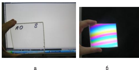
Рис. 2. Зразок: а – не зміцненого скла (СО 120), в якому немає внутрішніх напружень; б – зразок зміцненого скла (АО 120) з кольоровими смугами, які утворюються при взаємодії поляризованого випромінювання з внутрішніми напруженими шарами органічного скла
