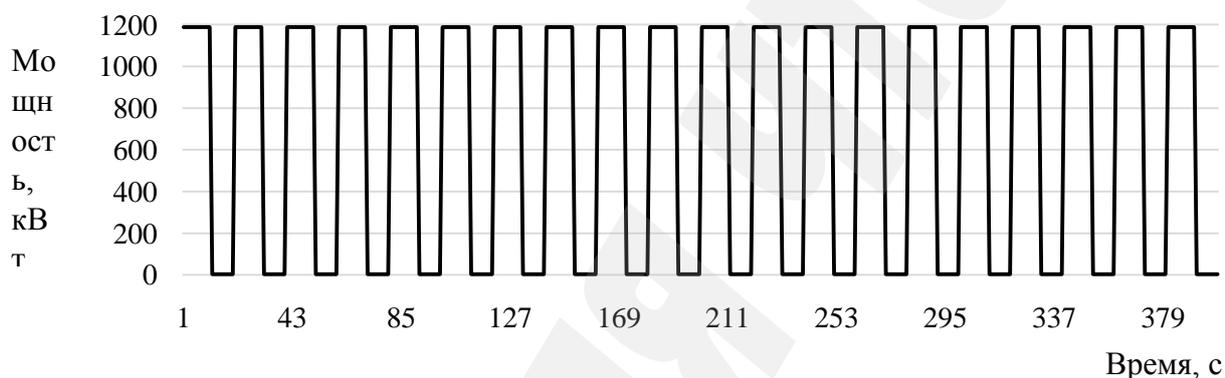
**Рис.11.** График оптимального периодического управления индуктором
