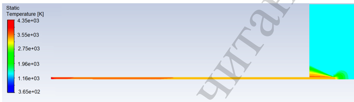
Рис. 2. Распределение полей температур по каналу ствола установки
