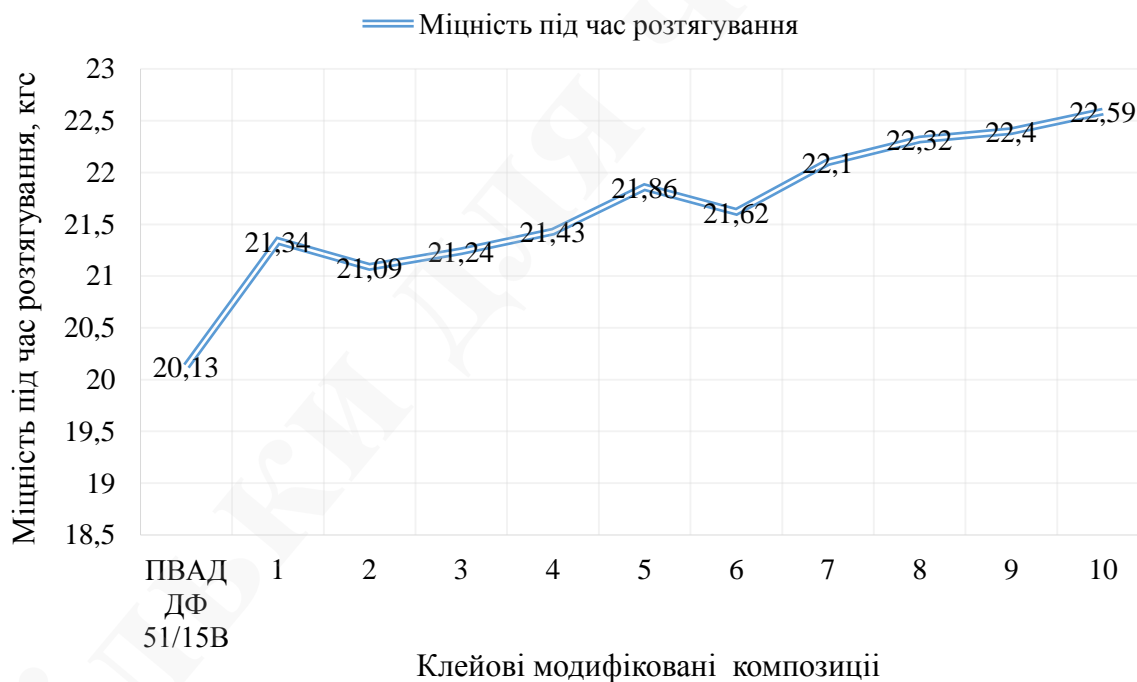
Рис. 3. Показники зміни міцності склеєних модифікованими клеями фрагментів напівжорстких обкладинок
