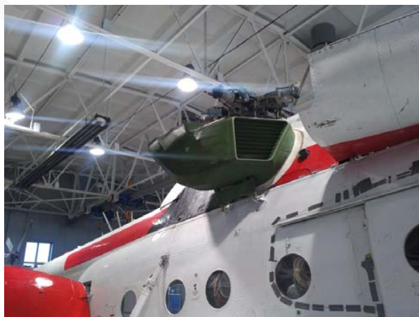
Рис. 7. Загальний вид екранно-вихлопного пристрою, що проходив випробовування у складі вертольоту Мі-8МСБ-В
