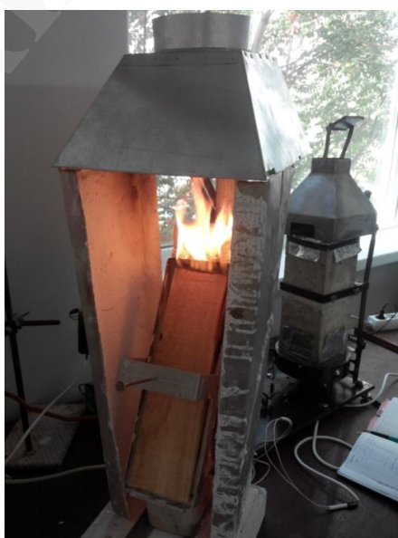
Рис. 5. Установка для визначення індексу поширення полум'я поверхнею деревини
