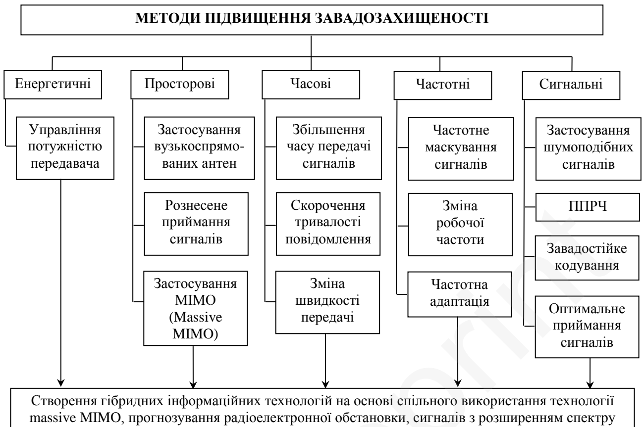
Рис. 3. Основні методи підвищення завадозахищеності систем і засобів радіозв'язку: ППРЧ – псевдовипадкова перестройка робочої частоти
