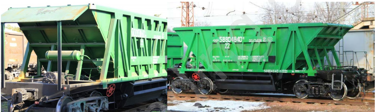
Рис. 1. Вагон-хопер для перевезення окатишів: а – вид з торця; б – вид з боку
