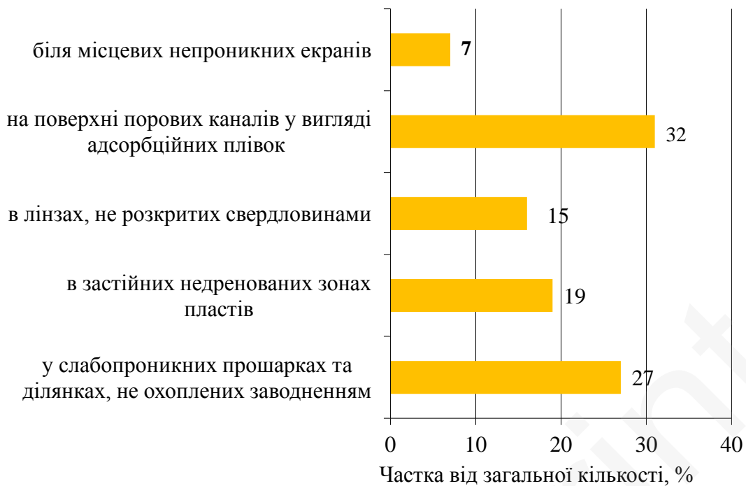
Рис. 2. Розподіл залишкової нафти в поровому просторі
