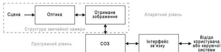
Рис. 1. Типова структурна схема побудови розумних камер (пунктирною рамкою виділені блоки спільні зі звичайними камерами)
