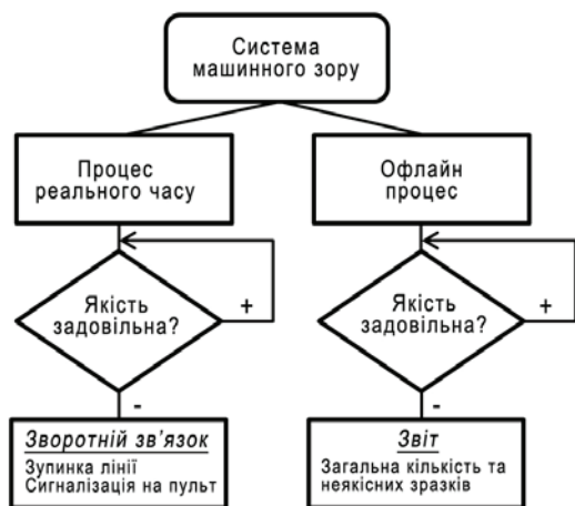
Рис. 2. Порівняння реакції системи машинного зору при застосуванні у процесах реального часу та офлайн
