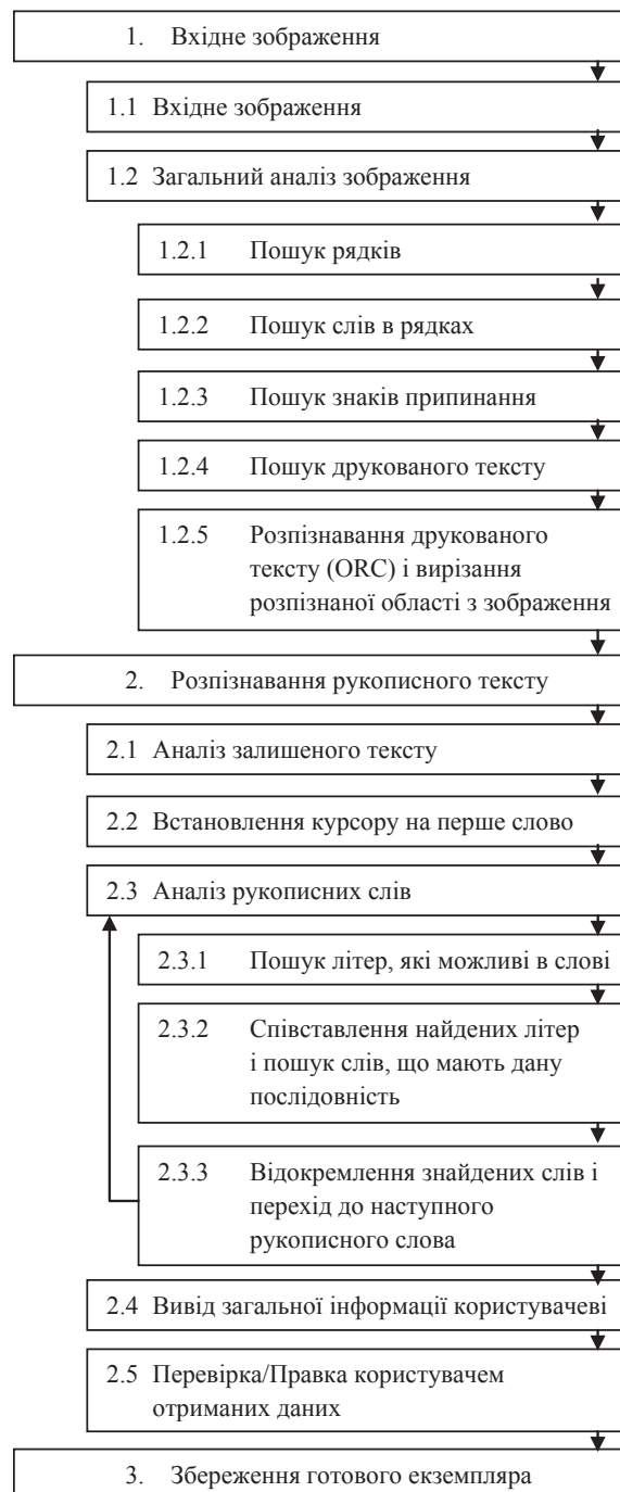
Рис. 2. Блок-схема алгоритму розпізнання рукописного тексту без його перетворення до рукодрукованого вигляду
