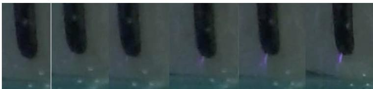
**Рис. 1.** Развитие катодонаправленного стримера в газовом пространстве над поверхностью дистиллированной воды. Скорость съемки 60 кадров/с
