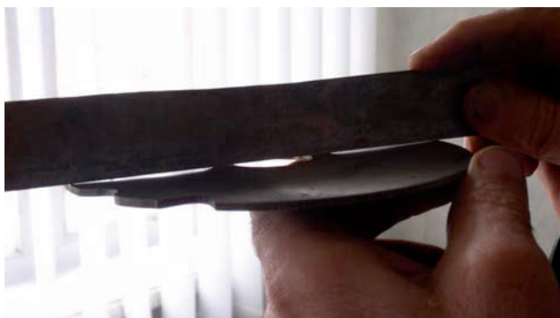
Рис. 3. Потоншення дискової пили у напрямку до осі обертання
