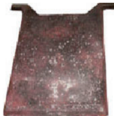
Рис. 6. Производство медных анодов на производственном металлургическом предприятии «Панком-Юн»: а — заливка изложниц; б — анод для производства катодной меди
