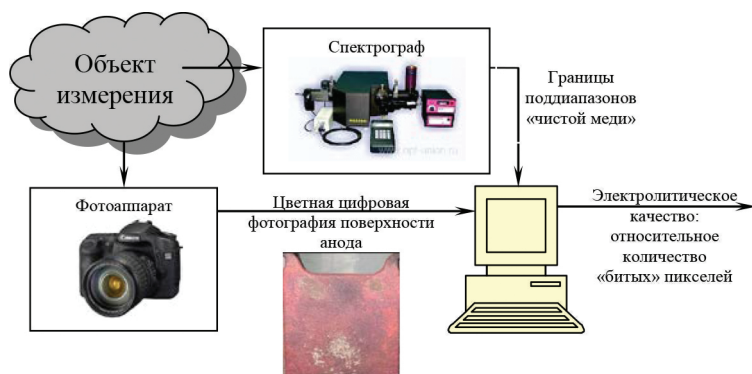
Рис 5. Схема метода измерения качества (относительного количества «битых» пикселей) литого медного анода
