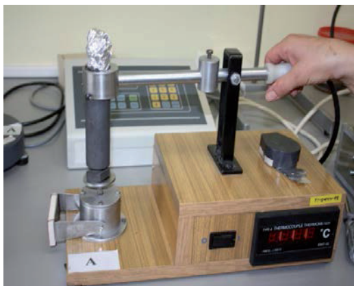
Рис. 3. Прилад для визначення термоопору шкіряного матеріалу
