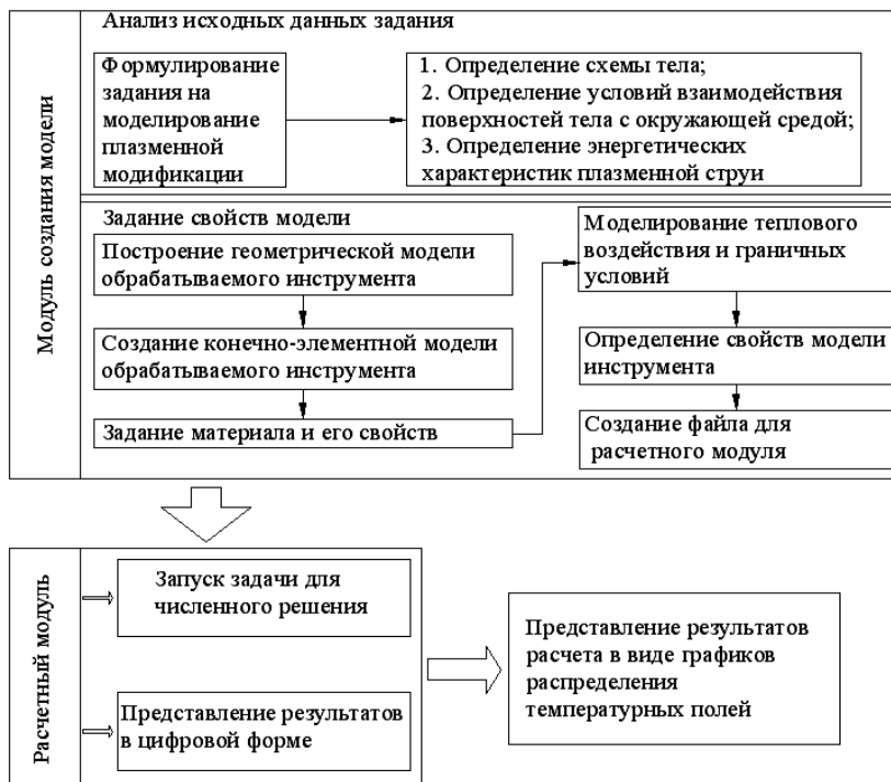
Рис. 1. Алгоритм моделювання процесу плазмової модифікації за допомогою системи FEMAP
