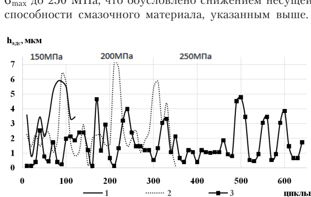
Рис. 2. Кинетика образования граничных смазочных слоев: 1 — покрытие 0,3 мм; 2 — покрытие 0,7 мм; 3 — покрытие 1,2 мм
