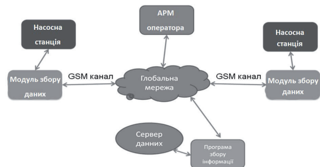
Рис. 1. Структурна схема системи збору даних про стан системи водопостачання
