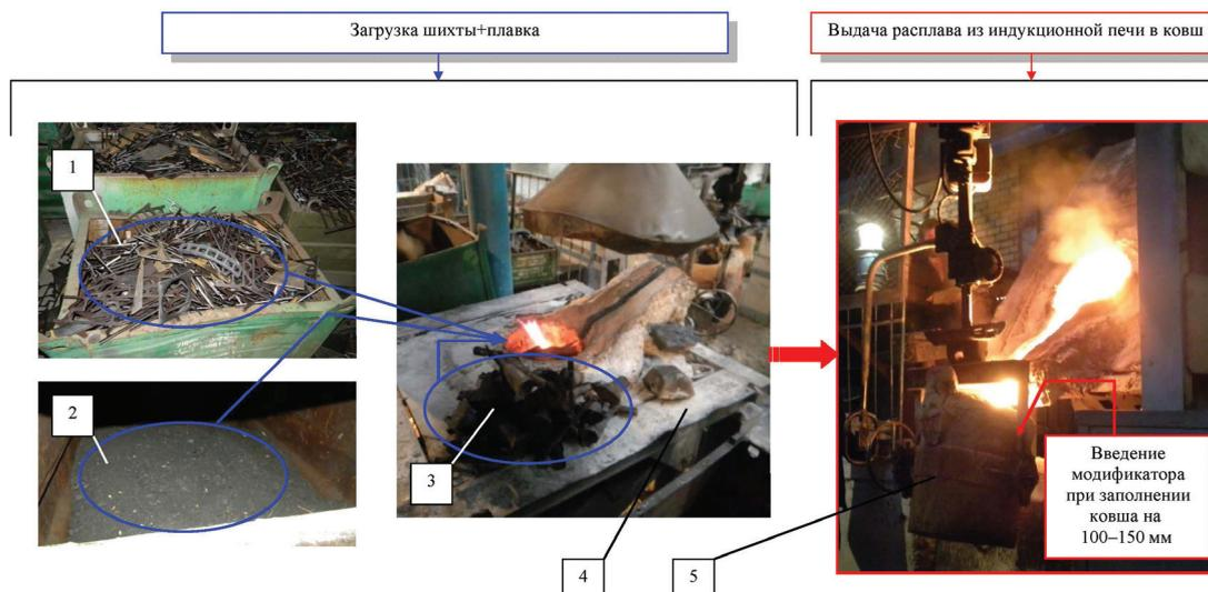
**Рис. 1.** Принципиальная схема процесса получения конструкционного чугуна в индукционной печи ИСТ1/0.8-М5: 1 – стальной лом, 2 – бой графитовых электродов, 3 – возврат собственного производства (литники), 4 – печь индукционная ИСТ1/0.8-М5, 5 – ковш
