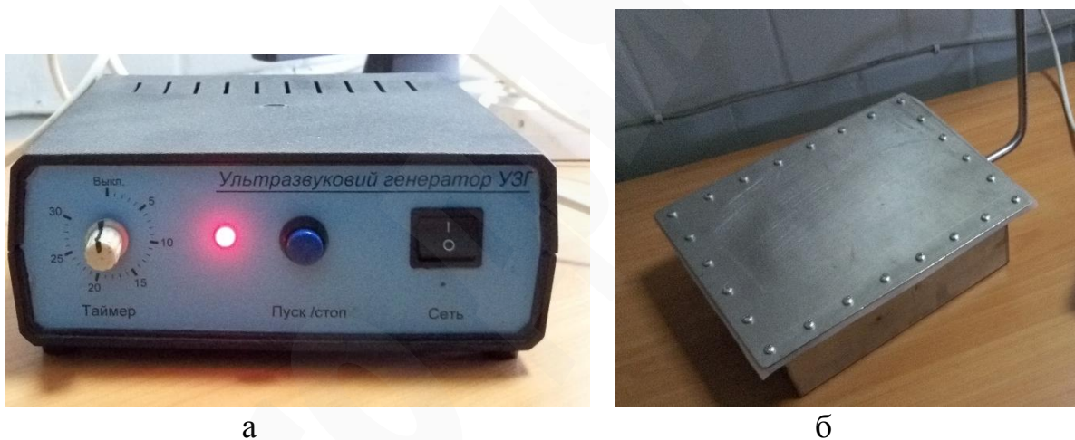
Рис. 2. Світлина ультразвукової установки: а – ультразвуковий генератор; б – ультразвуковий перетворювач 2 (погружний блок)
