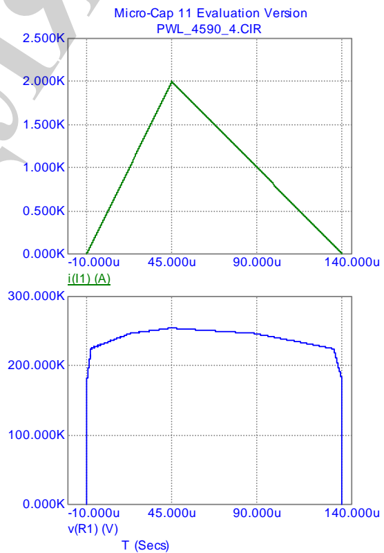
Рис. 2. Остающееся напряжение (внизу) при протекании через нелинейный ограничитель перенапряжений коммутационных импульсов тока (вверху) формой 45/90 мкс разной амплитуды: a – 0,25 кА; б – 0,50 кА; в – 1,0 кА; г – 2,0 кА
