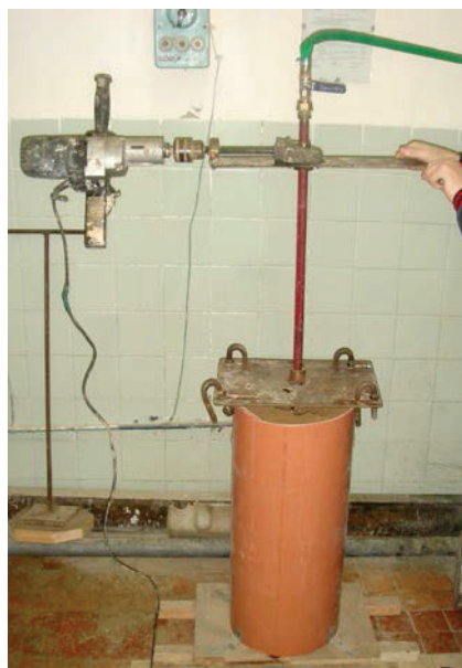
Рис. 2. Процес виготовлення ґрунтоцементних палей за бурозмішувальною технологією
