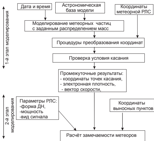
Рис. 1. Структурная схема модели метеорного радиоотражения
