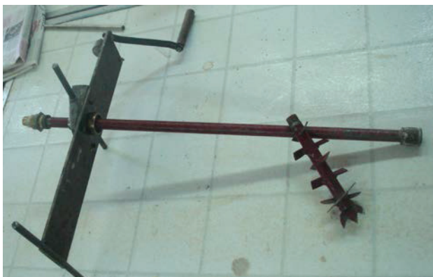
Рис. 1. Бурова установка для відтворення в лабораторних умовах бурозмішувальної технології влаштування ґрунтоцементних палей без виймання ґрунту
