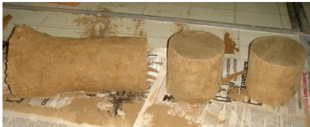
Рис. 6. Розрізання палі на зразки для випробувань
