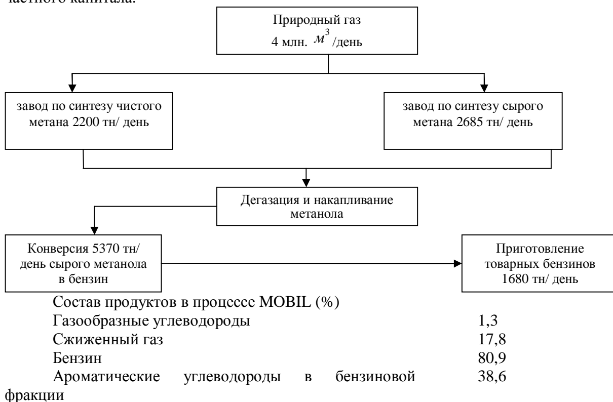
Рис. 2. – Технологическая схема получения бензина через метанол по процессу MOBIL
