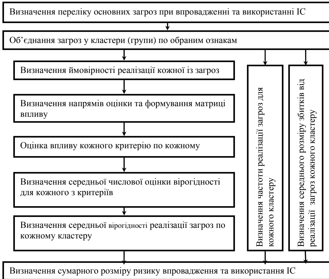
Рисунок 3. Алгоритм визначення розміру ризику при впровадженні та використанні ІС.
