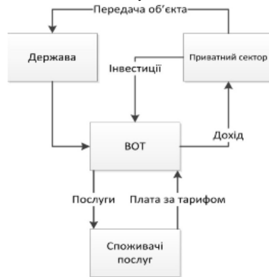
Рис. 4 Типова схема моделі ВОТ
