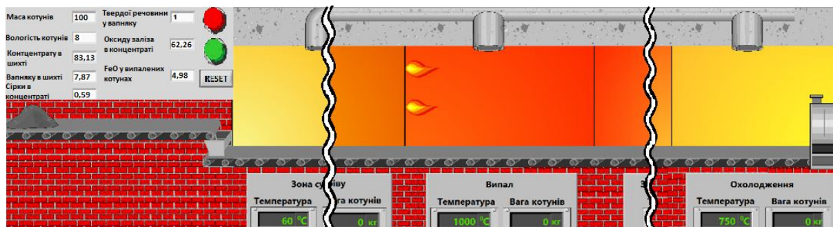
Рис. 1 – Фронтальна панель моделі процесу випалу котунів у середовищі LabVIEW
