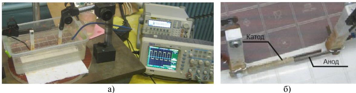
Рис. 1 – Фотографії експериментальної установки: а) – загальний вигляд стану, б) – робоча зона електрохімічного розчинення
