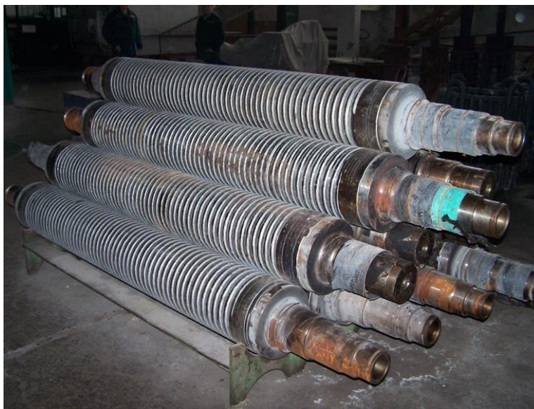
Рис. 1 – Наплавленные ролики МНЛЗ на участке ремонтно-механического завода ООО «МЕТИНВЕСТ-МРМЗ»
