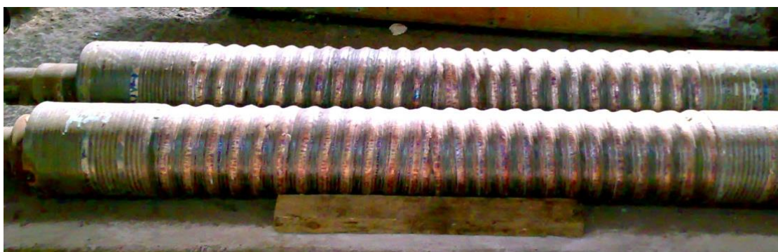
Рис. 3 – Внешний вид роликов, наплавленных с зазором между смежными валиками с наклоном в разные стороны от середины к краям
