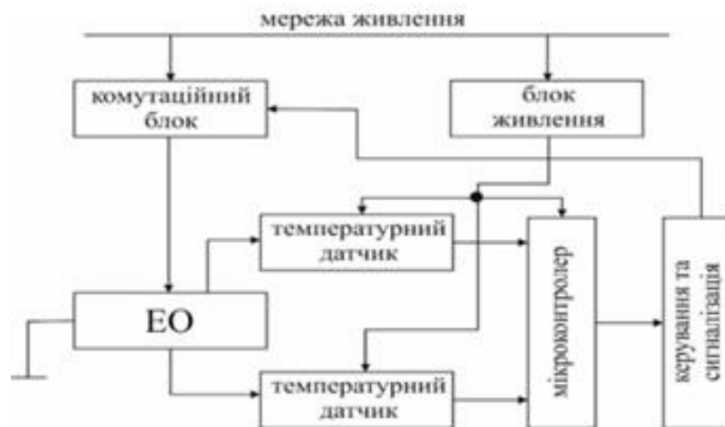
Рис. 3 – Блок-схема пристрою діагностики теплового навантаження та температурного захисту АД
