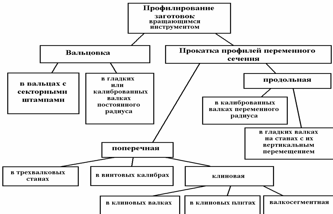
Рис. 4 – Классификационная схема способов профилирования прокаткой и вальцовкой (по К.А. Гогаеву [27])
