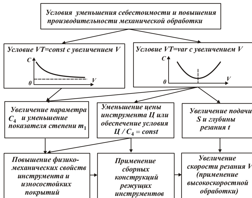
Рис. 1 – Структурная схема условий уменьшения себестоимости и повышения производительности механической обработки
