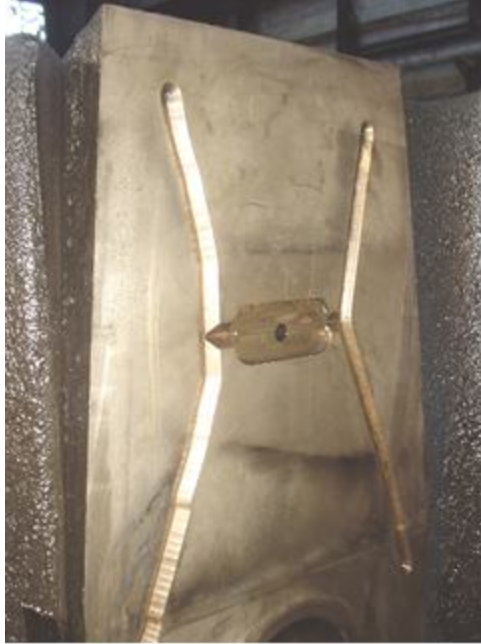
Рис. 2 – Вкладыш с изменённым расположением смазочных канавок
