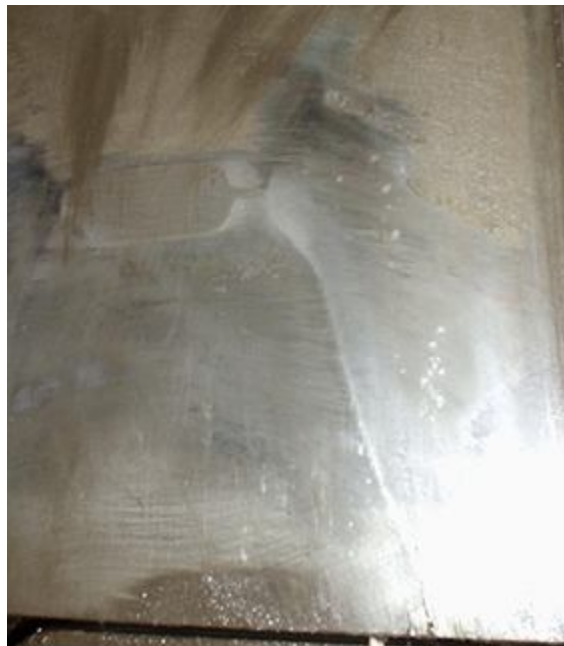
Рис. 3 – Изменение характера изношенной поверхности при изменении характера распределения смазочного материала
