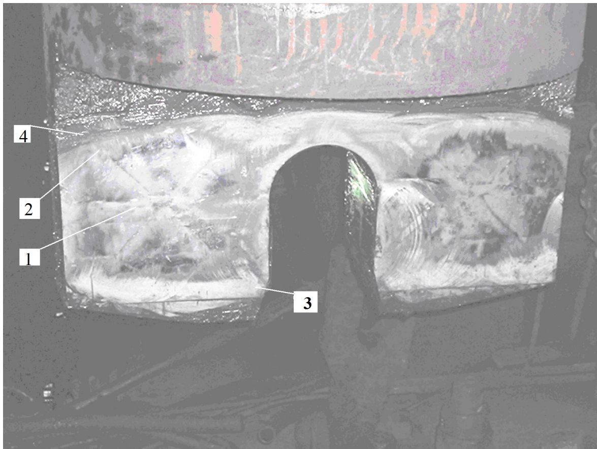
Рис. 1 – Вид изношенной поверхности лопасти: 1 – зона с контактным отпечатком поверхности вкладыша; 2 – поверхность, подвергшаяся окислительному износу, активированная воздействием геомодификатора; 3 – поверхность, подвергшаяся абразивному износу, активированная воздействием геомодификатора; 4 – поверхность, не подвергшаяся воздействию геомодификатора
