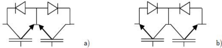
Рис. 3 – Двухнаправленные ключи: а – с общим эмиттером; б – с общим коллектором
