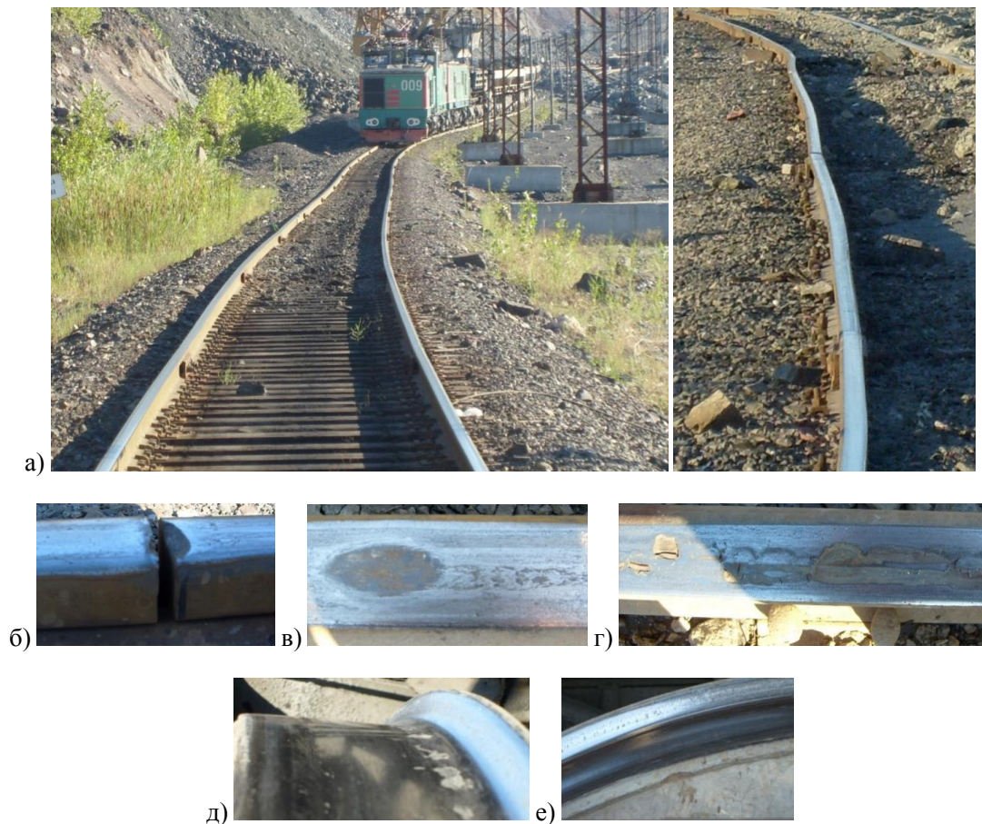
Рис. 5 – Фрагменти стану рейкового полотна і стану колісних пар: а – загальний вигляд; б – розрив; в – виїмка; г – вищербленість; д – зміна діаметра колеса; е – вищербленість колеса
