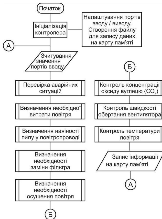
Рис. 4 – Алгоритм роботи блоку управління фільтрувального респіратору з примусовою подачею повітря
