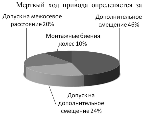
Рис. 7 – Зависимость мертвого хода от различных факторов
