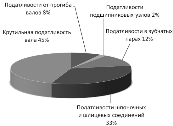
Рис. 2 – Баланс податливостей замкнутого привода
