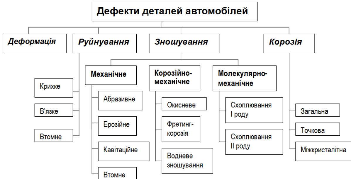
Рис. 1 – Характерні дефекти деталей автомобілей
