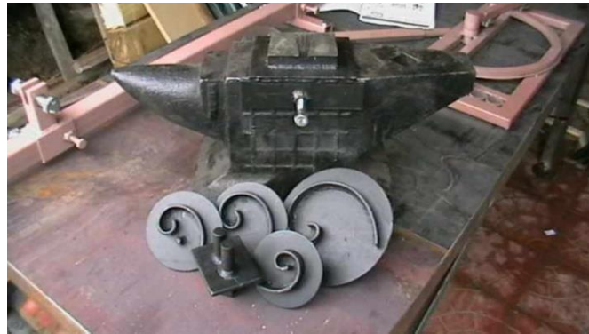
Рис. 2 – Ковадло та шаблони для художнього кування
