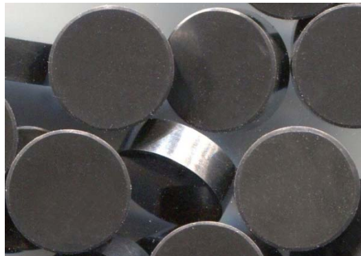
Рис. 1 – Круглі різальні пластини RNGN 090300T, виготовлені з КМК системи cBN-TiC (cBN(КМ 3/2) + TiC ( \leq 4,5-7 мкм), 45 об.% після механічної обробки
