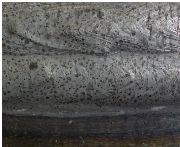
Рис. 1 – Наплавленный металл порошковой проволокой ПП-Нп-4Х12Г12СТ под 100% флюса АН-26П
